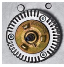
Freno con cuerpo disipador para evitar su calentamiento
