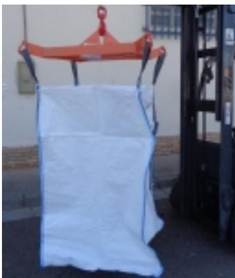
Acessório grua para pegar BIG-BAG nos seus respectivos ganchos de fixação. Fabricado em aço perfilado muito resistente. Capacidade de carga 2.000 Kg. Dimensiones 1.342 x 1.342 x 255 mm. Peso 28 Kg.
