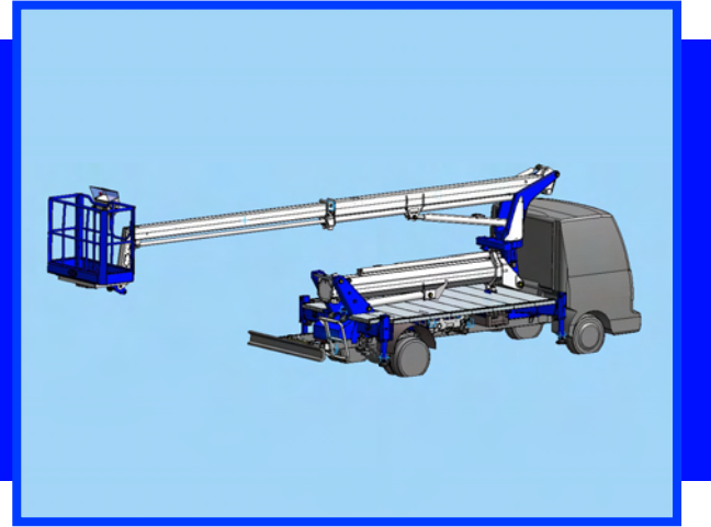
Possibilità di lavorare senza stabilizzatori in un cono posteriore e per un'altezza di 13mt "modalità di lavoro 0" Possibility of working without stabilisers in a rear area and for a height of 13 m - First configuration
