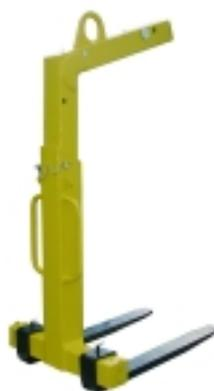
Porta-paletes com equilibrado automático em função do peso. Garfos móveis desde 450 até 900 mm, para a elevação de cargas até 3.000 kg, perfeito para transportar todas as mercadorias sobre paletes a través duma grua. Fabricado em aço muito resistente.
