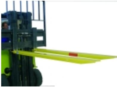
Garfos de empilhador, a melhor solução para melhorar a segurança e as prestações dum empilhador. Largura exterior 130. Fabricadas em aço muito resistente. (Indicar medidas dos garfos e comprimento necessário).
