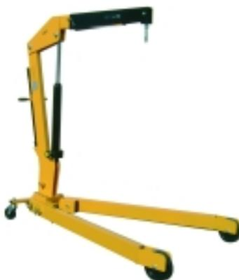
Grua dobrável de 1.000 kg, controlada através duma bomba manual, muito manobrável. Possui rodas dianteiras de nylon. Possibilidade de posicionar o braço da grua em três posições diferentes. Gancho forjado muito resistente e giratório. Marcado CE.
