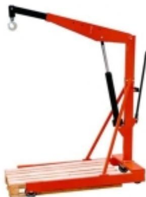
Grúa de 1.000 kg, para pallet Europeia. Controlada através duma bomba manual, muito manobrável. Possui rodas dianteiras de nylon. Possibilidade de posicionar o braço da grúa em três posições diferentes. Gancho forjado muito resistente e giratório. Marcado CE.
