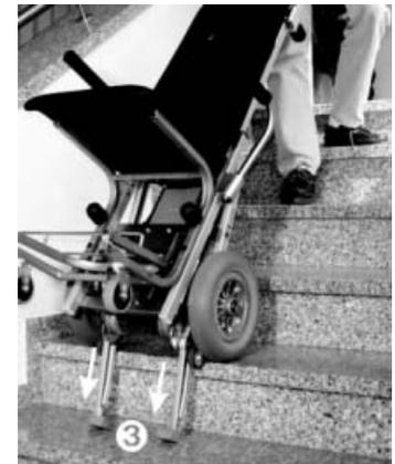
Después de que las patas de trepado hayan alcanzado el peldaño inferior de la escalera ④, estas patas se harán cargo de la carga de las ruedas y éstas, así como el soporte, serán elevados un poco del peldaño superior ⑤ y a continuación movidas del camino del usuario en dirección escalera abajo.
