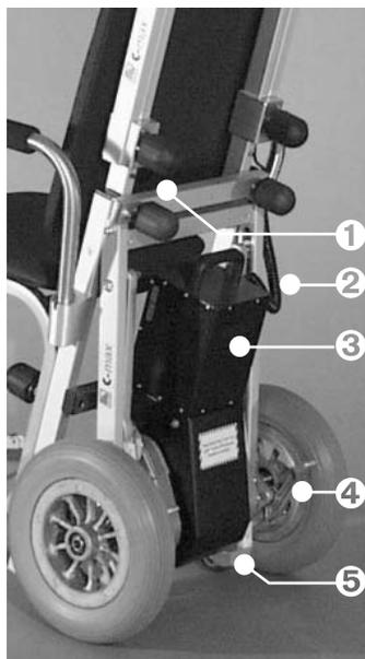
El primer ciclo se termina cuando las ruedas se apoyan en el peldaño inmediatamente superior ❹ y la carga es soportada de nuevo por las patas de trepar.
