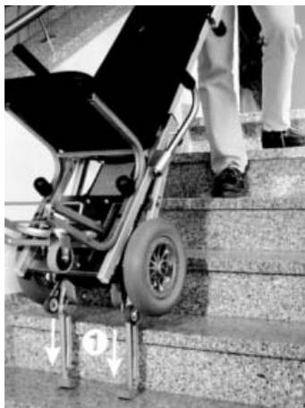
Una vez que hayan alcanzado el suelo, las patas de trepar ❷ soportan la carga de las ruedas y las ruedas y el bastidor ❸ se levantan.
