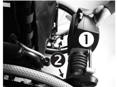
☞ Coloque el max-e con sus anclajes a la silla de ruedas ❶ en línea recta con la sujeción ❷.
