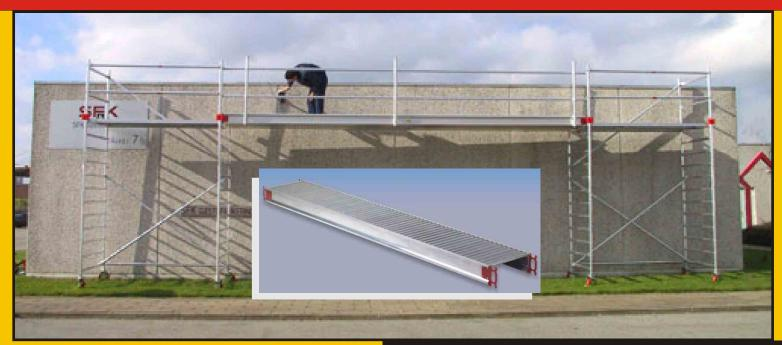
PASSATEMPO è un sistema di passerella in alluminio estremamente leggero e maneggevole. Le passerelle possono essere unite e formare un piano di calpestio unico od essere capovolte per diventare una passerella singola dotata di fermapiede integrato. Ogni passerella è dotata di ganci alle estremità per essere montate su tubi ø 50 mm (Tempo). Bastano pochi minuti per ottenere un camminamento comodo, leggero ed inattaccabile dalla ruggine.
