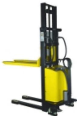
Stacker de traslação manual e elevação eléctrica a bateria de 12V, com grande facilidade de manobra. Leme ed direcção com mola de retorno. Autonomia de 3 Horas em contínuo. Elevação até 2.500 mm. Rede de protecção. Rodas traseiras com travão. Carregador incorporado. Marca CE.
