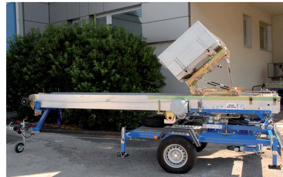
UNIVERSAL BASKET WITH ROTATION AND SLIDING SYSTEM (ALL VERSIONS) - PANIER UNIVERSEL AVEC SYSTÈME DE ROTATION ET GLISSEMENT (TOUTES LES VERSIONS) - CESTA UNIVERSAL CON SISTEMA DE ROTACIÓN Y DESLIZAMIENTO (TODAS LAS VERSIONES) - UNIVERSALKORB MIT ROTATIONS- UND GLEITSYSTEM (ALLE VERSIONEN)
